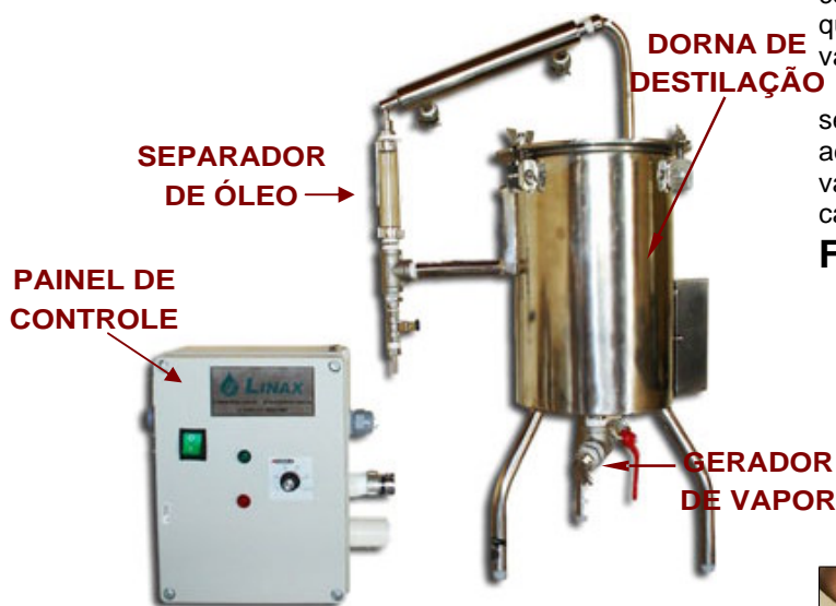
FIG. 1 - APARELHO E COMPONENTES PARA DESTILAÇÃO.
